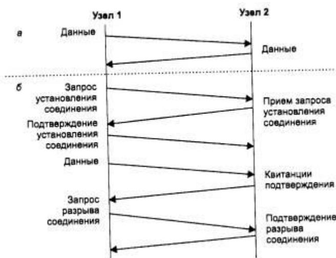
**Рис. 5.3.** Протоколы без установления соединения (а) и с установлением соединения (б)
